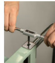
When hand tapping, always use tap wrench ในการต๊าบด้วยมือนี้ มักใช้ประแจ ช่วยในการต๊าบ
