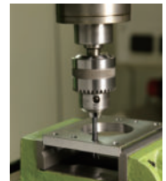
Machine tapping with drilling machine เครื่องต๊าบด้วยเครื่องเจาะ
