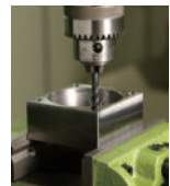
Machine tapping with drilling machine เครื่องตัดด้วยเครื่องเจาะ
