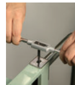
When hand tapping, always use tap wrench ในการตัดด้วยมือนี้ มักใช้ประแจ ช่วยในการตัด
